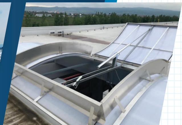
**Der Firelock ARCH** besteht aus einem verschweißten gebogenen Aluminiumrahmen, einem Lüftungsflügel, einer Quertraverse und einer pneumatischen Steuerung für die NRWA Funktion.
